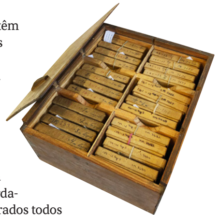
Caixa com o conjunto de matrizes Monotype do tipo Spartan Light, Bold e Wide, corpos 6 e 12.
